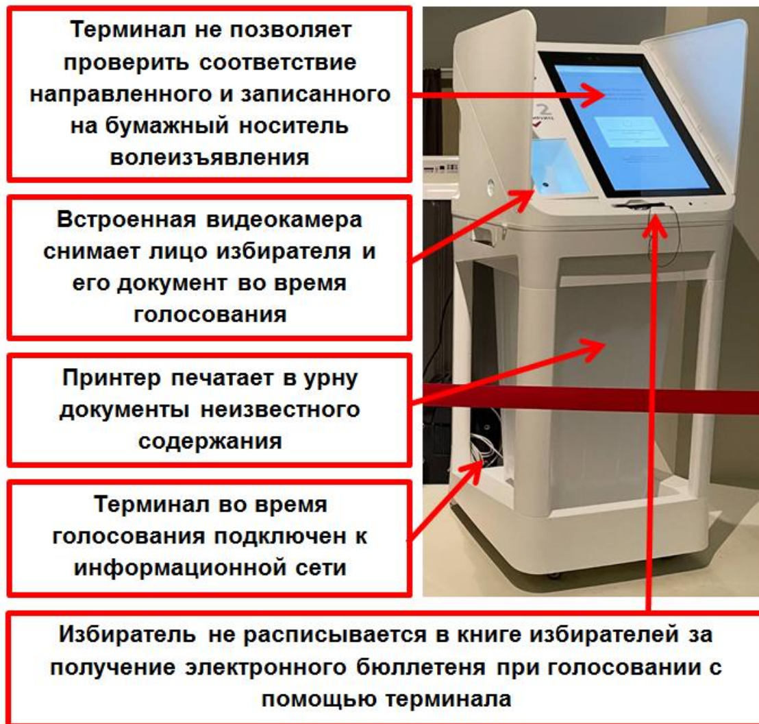
Рисунок 1 — Внешний вид московского ТЭГ, подходящего под новое определение КЭГ в законопроекте, с перечнем конструктивных уязвимостей и недостатков
